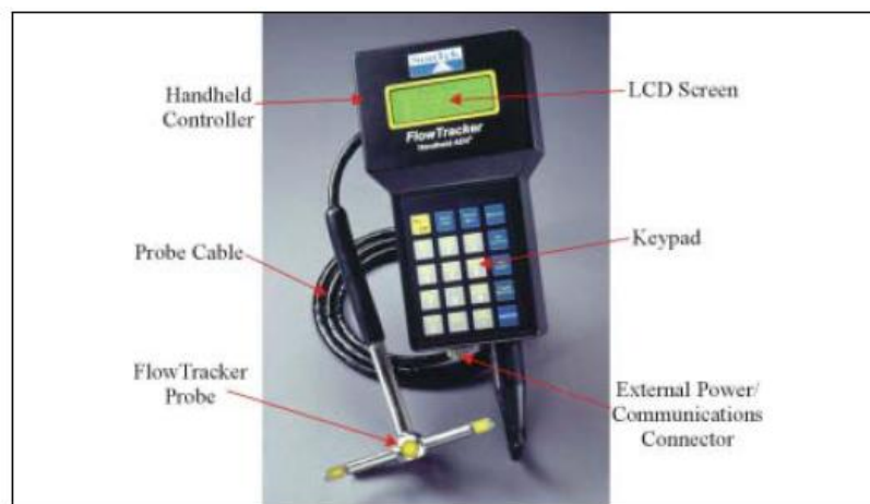
Figure 36 : Appareil Flow Tracker avec sonde 2D
